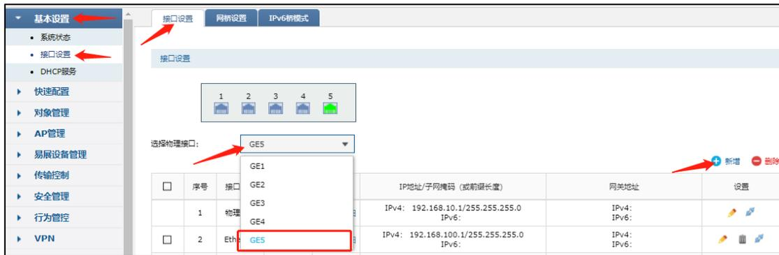
以研发网段为例，其他 VLAN 的设置也是相同操作。点击<新增>，设置关联“VLAN20”，设置“IP”和“子网掩码”，点击<确定>。
