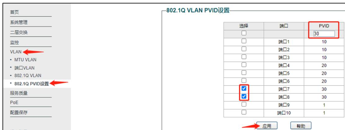
**注意：**修改端口 VLAN 配置可能导致部分端口无法进入交换机界面，应选择不会修改 VLAN 配置的端口或者上联口进入交换机界面。
