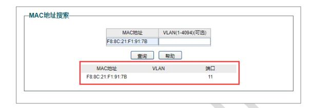
这样就可以查到这个异常终端所接入的端口,为交换机的 11 口,现在拔除掉 11 端口网线 就可以将这个异常终端从网络中移除,保障了网络的安全性。
