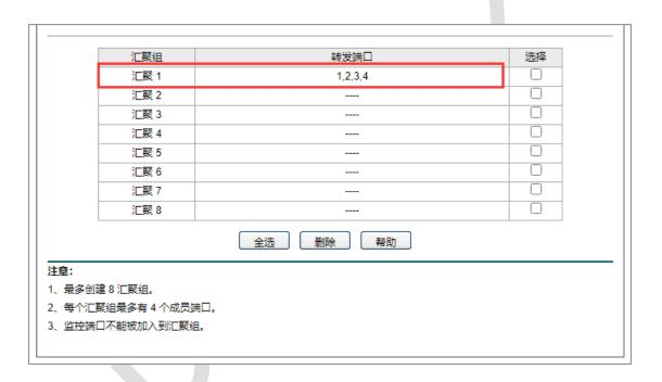
同样的设置方法在另外一台云交换上将 1-4 口设置成汇聚口,然后两台交换机的 1-4 口对接起来,便完成了云交换的端口汇聚功能。
