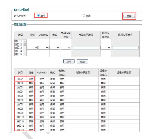
这样交换机上所接入的终端就只能从 1 口上联的设备获取地址,不会从其余端口的非法 DHCP 服务器获取地址,保障了网络的安全性。
