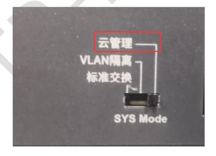
2、云交换模式下设备上电,接入前端可以联网且可以自动分配地址的网络中,此时交换机将自动从前端获取 IP 地址,并且将会用这个 IP 地址去连接网络(确认交换机所获取的地址,网关以及 DNS 服务器是可以正确联网的)。
