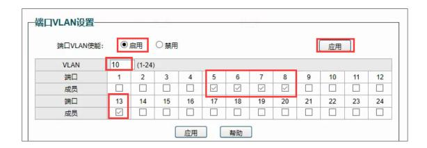
3、默认 VLAN 1 需将两个部门所属的端口剔除出去。完成后,VLAN 列表如下:
