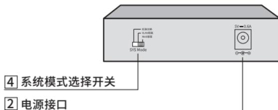
图1-4 TL-SG2005后面板示意图
