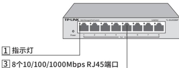
图1-5 TL-SG2008MP前面板示意图
