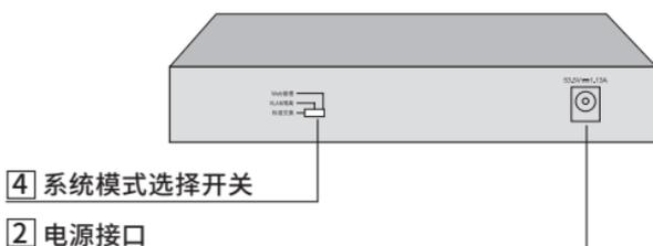
图1-6 TL-SG2008MP后面板示意图
