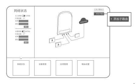
3) 将子路由接通电源,子路由系统指示灯绿色常亮,待系统指示灯闪烁2秒后,按下子路由配对按钮。 子路由系统指示灯红色快闪,点击"**下一步**"。
