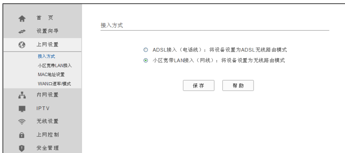
图 26 小区宽带 LAN 接入方式
