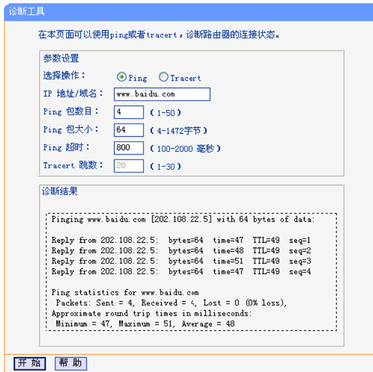
图 5-54 Ping 诊断结果—成功
