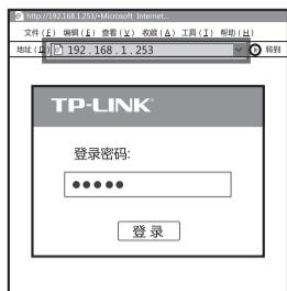
2 进入路由器设置界面，点击左侧导航栏中“设置向导”，在出现的界面中点击“下一步”。
