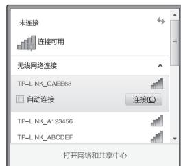
2 若在“3 计算机设置路由器”中对无线网络设置了加密，系统会弹出如下提示框，填入设置好的密码，点击“确定”即可。
