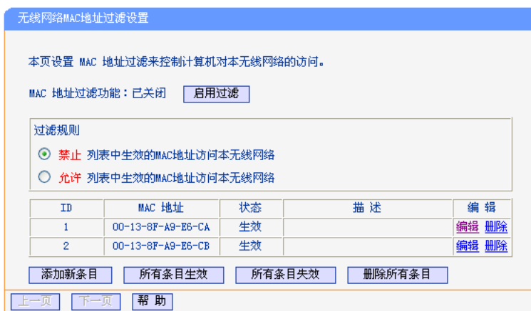
图 5-35 无线网络 MAC 地址过滤设置
