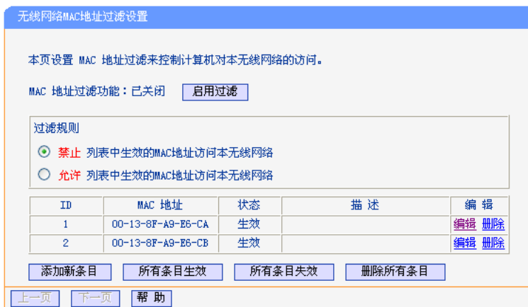
图 5-21 无线网络 MAC 地址过滤设置
