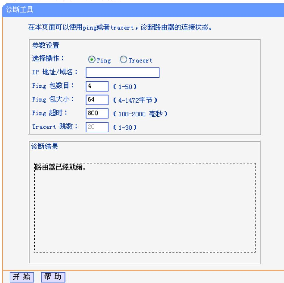
图 5-15 诊断工具
