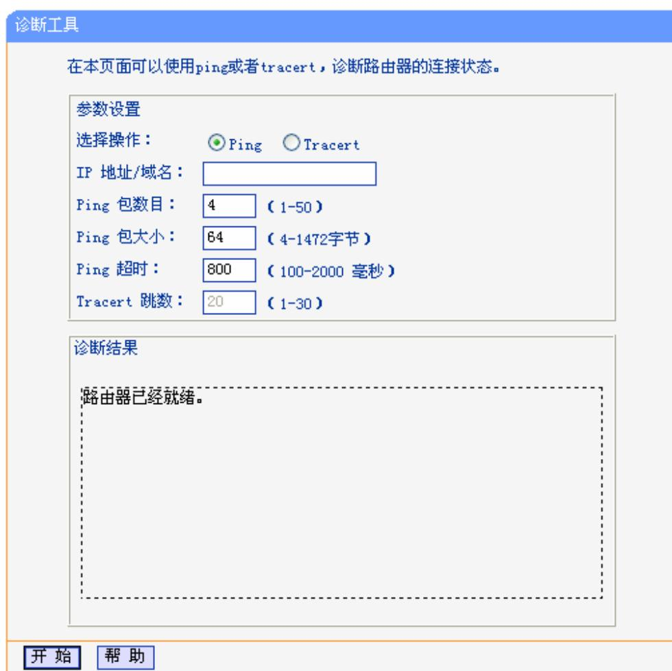
图 6-48 诊断工具
