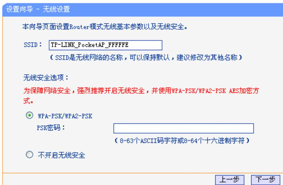
图 4-6 设置向导-Router 模式无线设置
