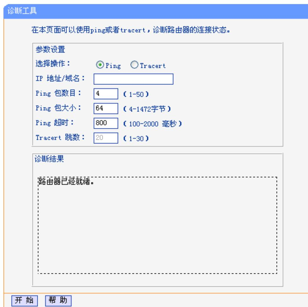
图 8-11 诊断工具
