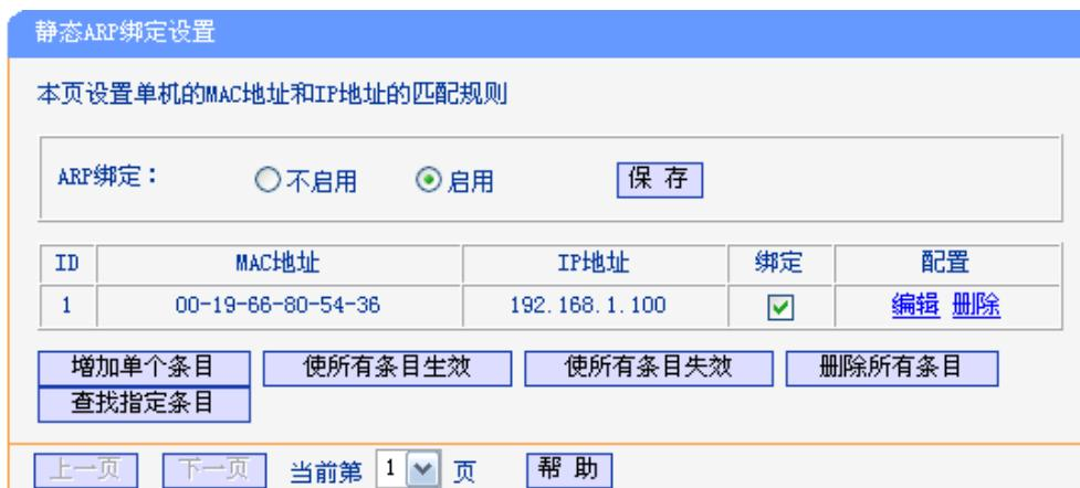
图 6-43 静态 ARP 绑定设置
