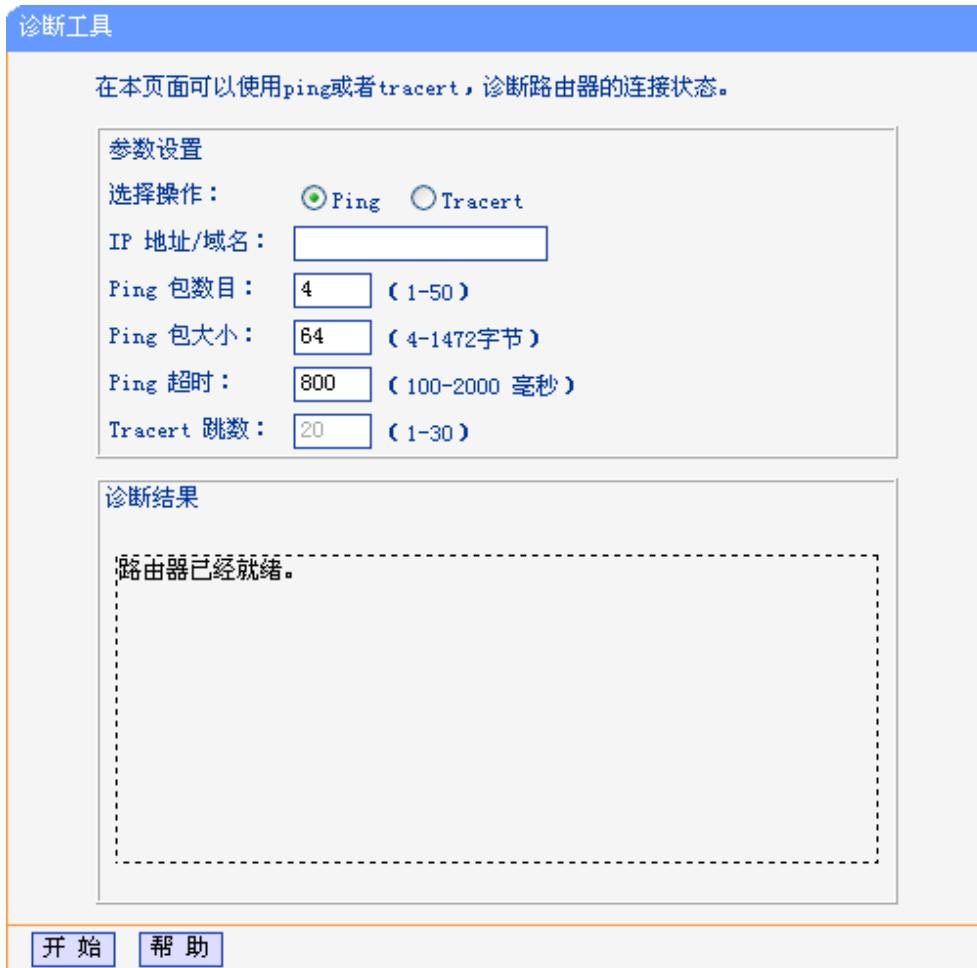
图 9-10 诊断工具
