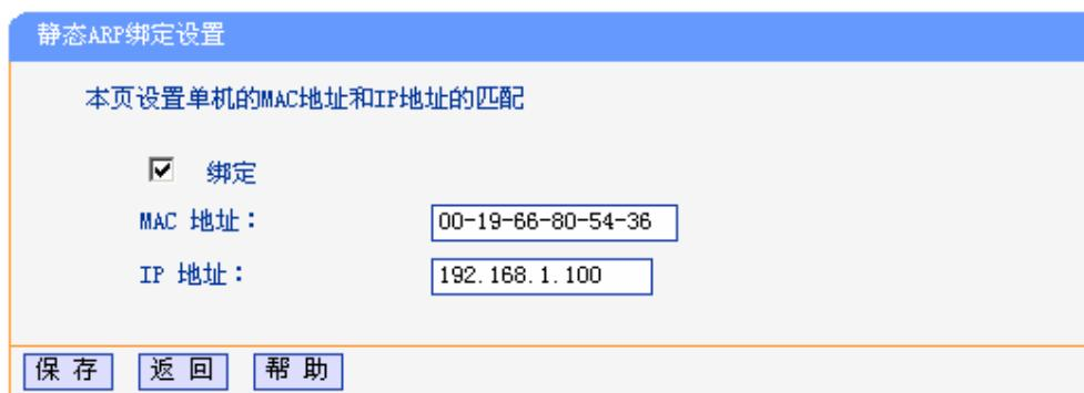
图 6-44 添加静态 ARP 绑定条目
