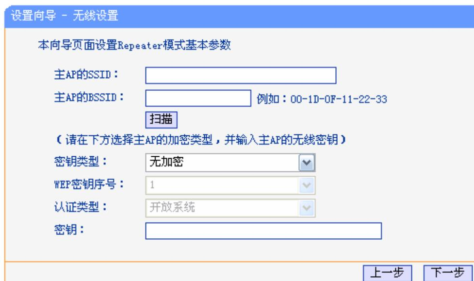
图 4-10 设置向导-Repeater 模式无线设置
