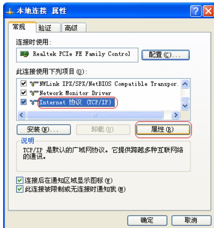
4. 弹出“Internet 协议 (TCP/IP) 属性”框，可通过以下两种方式获得 IP 地址：
