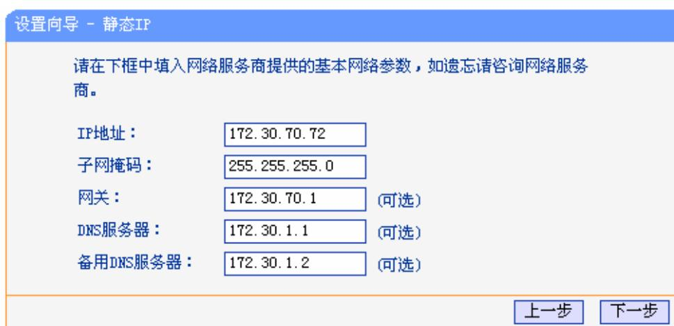
图 4-9 设置向导-静态 IP
