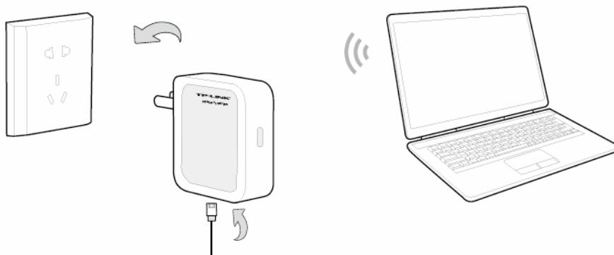
图 4-1 TL-WR710N 硬件安装示意图
