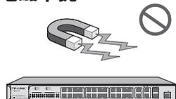
电磁干扰会以电容耦合、电感耦合、阻抗耦合等传导方式对设备内部的电容、电感等电子元器件造成影响，为减少电磁干扰因素造成的不利影响，请注意以下事项：
