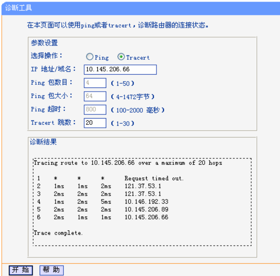
图 5-51 Tracert 诊断结果—成功
