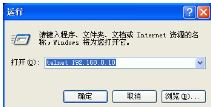
3. 进入「Telnet 192.168.0.10」窗口→「Password」字符串：输入打印服务器密码。
