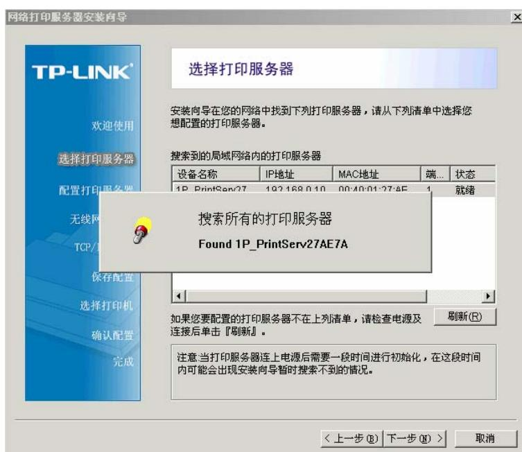
3. 在「检测局域网络内的打印服务器」列表中选择要配置安装的打印服务器，之后请单击「下一步(N)」。
