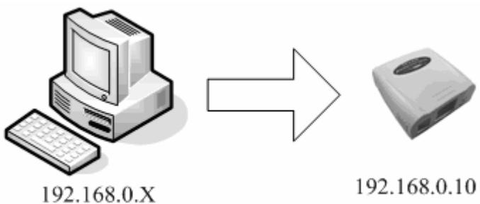
2. 以 Windows 操作系统，打印服务器 IP 地址 192.168.0.10 为例，单击「开始」→「运行 (R) ...」→「打开 (O):」字段输入：「tftp 192.168.0.10 get config.txt」→「确定」。
