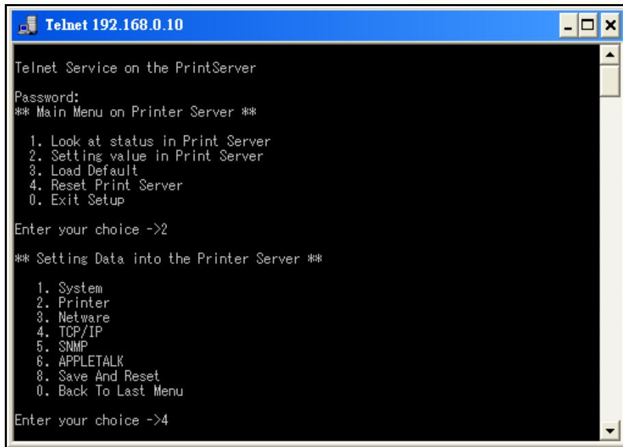
6. 「TCP/IP Setup」步骤，输入「2」进入「Specify IP」指定IP地址给打印服务器。
