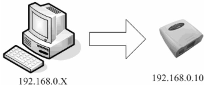
2. 以 Windows XP 操作系统，打印服务器 IP 地址 192.168.0.10 为例，单击「开始」→「运行 (R) ...」→「打开 (O):」字段输入：「telnet 192.168.0.10」→「确定」。
