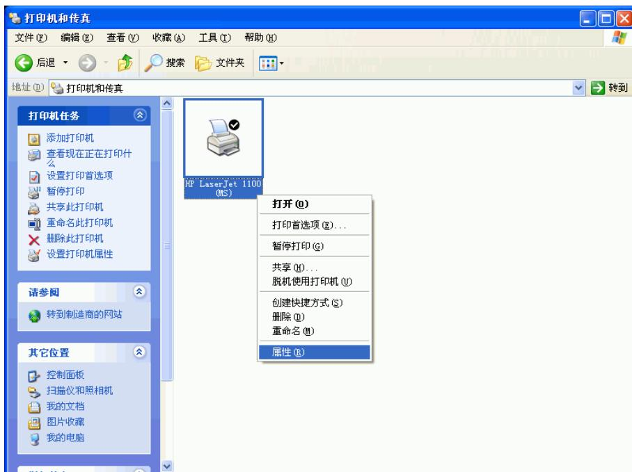
5.4.11 此时会出现打印机属性窗口，点选「常规」标签页，单击「打印测试页(T)」，正常印出测试页即完成配置步骤。
