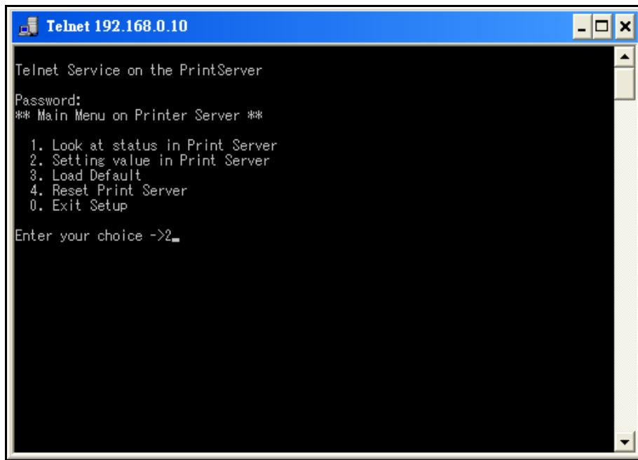
5. 「Setting Data into the Printer Server」步骤，输入「4」进入「TCP/IP」修改打印服务器的IP地址。
