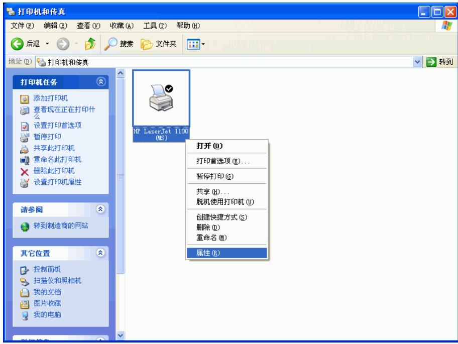
5.3.16 此时会出现打印机属性窗口，点选「常规」标签页，单击「打印测试页(T)」，正常印出测试页即完成配置步骤。
