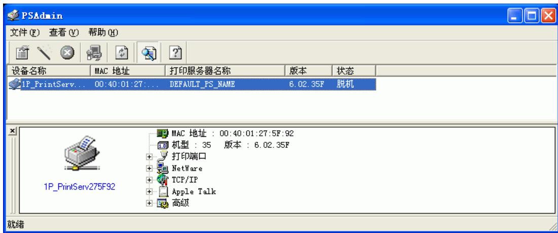
3. 「常规」页面，可配置打印服务器「设备名称」及「密码」配置。
