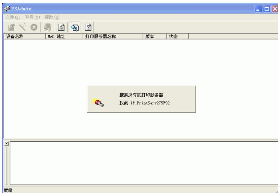
2. 找到的打印服务器就会列在表中，选择要配置的打印服务器后单击「 属性」钮。
