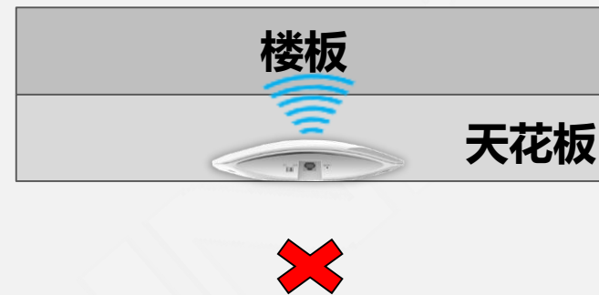
平放吊顶上安装
