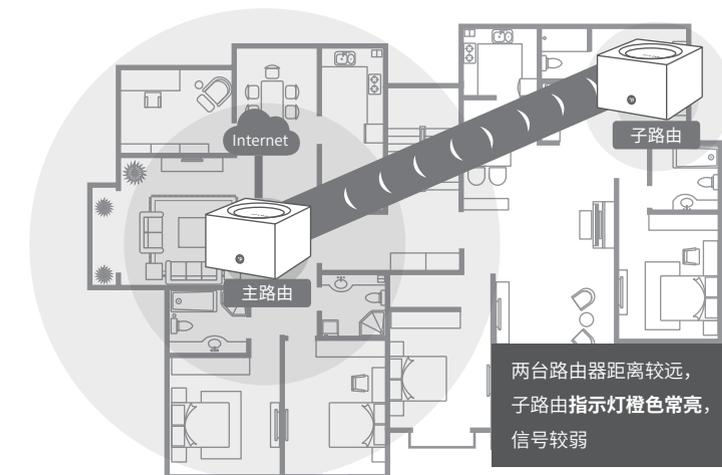
\*分布式Wi-Fi网络最多可实现8台（1+7）TP-LINK“易展”路由器同时连接。
