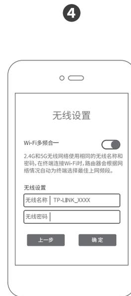
**设置无线名称和无线密码**，点击“确定”，完成设置。路由器即可正常上网。
