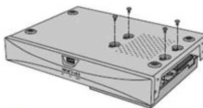
2 将硬盘固定在NVR底部
