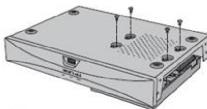
2 将硬盘固定在NVR底部
