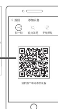
2.登录“TP-LINK安防”APP，进入添加设备界面，选择“扫一扫”可扫描产品底部标贴上的二维码快速添加NVR。也可以选择自动发现或手动添加的方式添加NVR。
