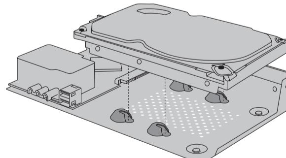
3. 推动硬盘，将硬盘插入对应的硬盘插座中，再拧紧硬盘固定螺丝。
