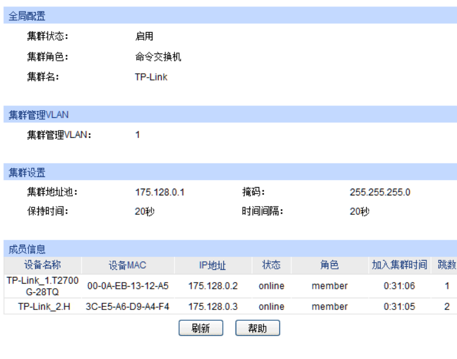
图 17-10 命令交换机的配置显示
