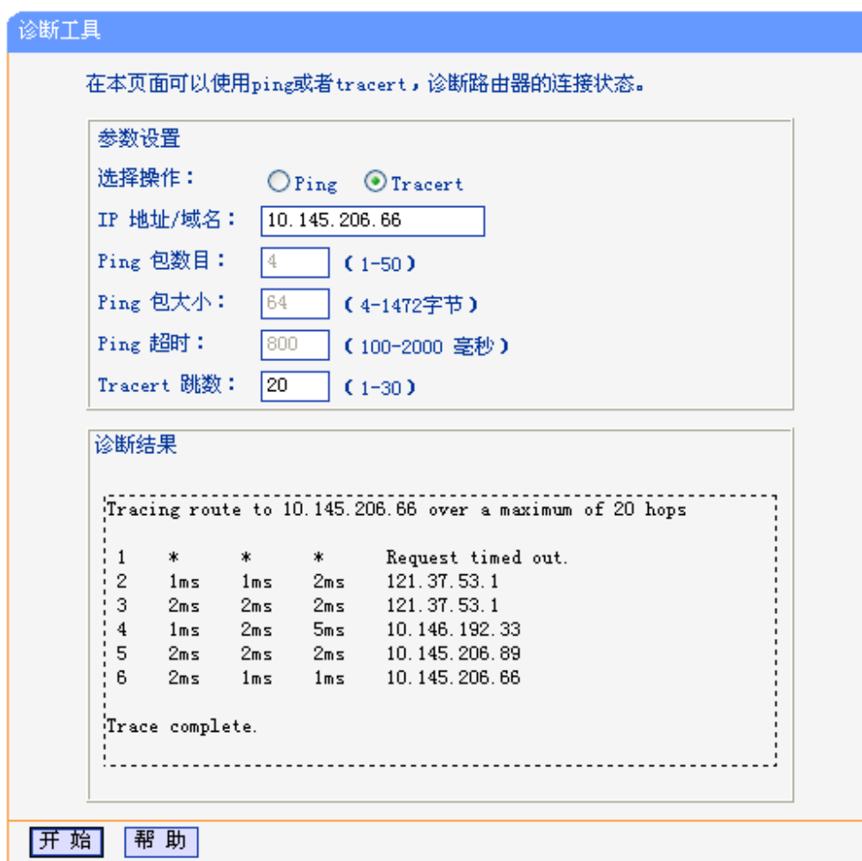
图 5-73 Tracert 诊断结果—成功
