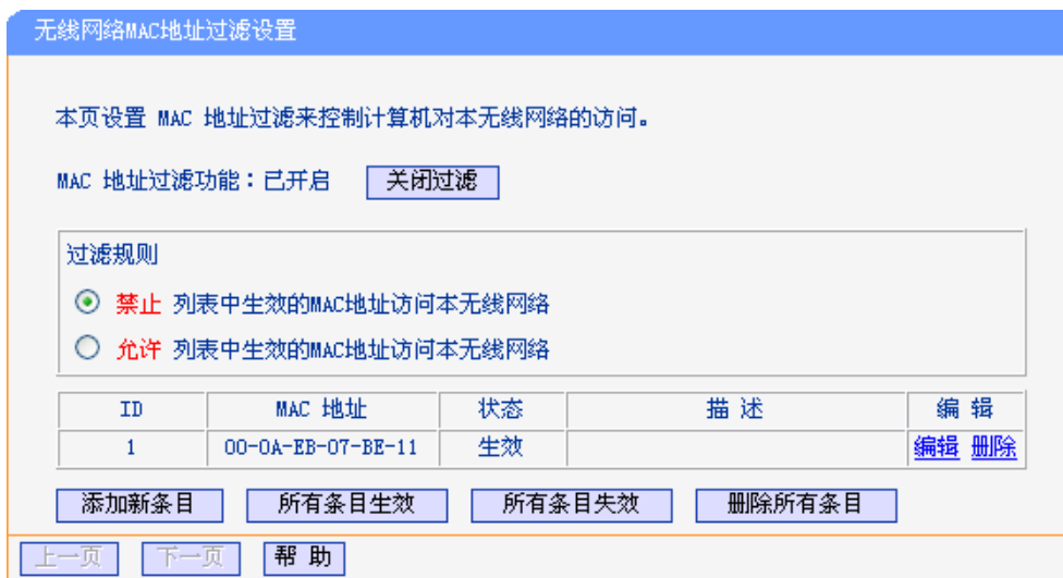
图 5-22 无线网络 MAC 地址过滤设置
