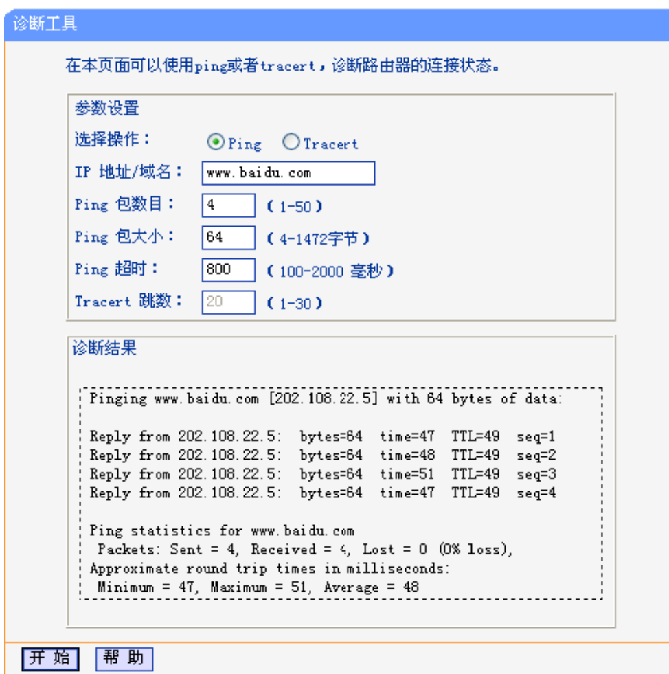
图 5-71 Ping 诊断结果—成功
