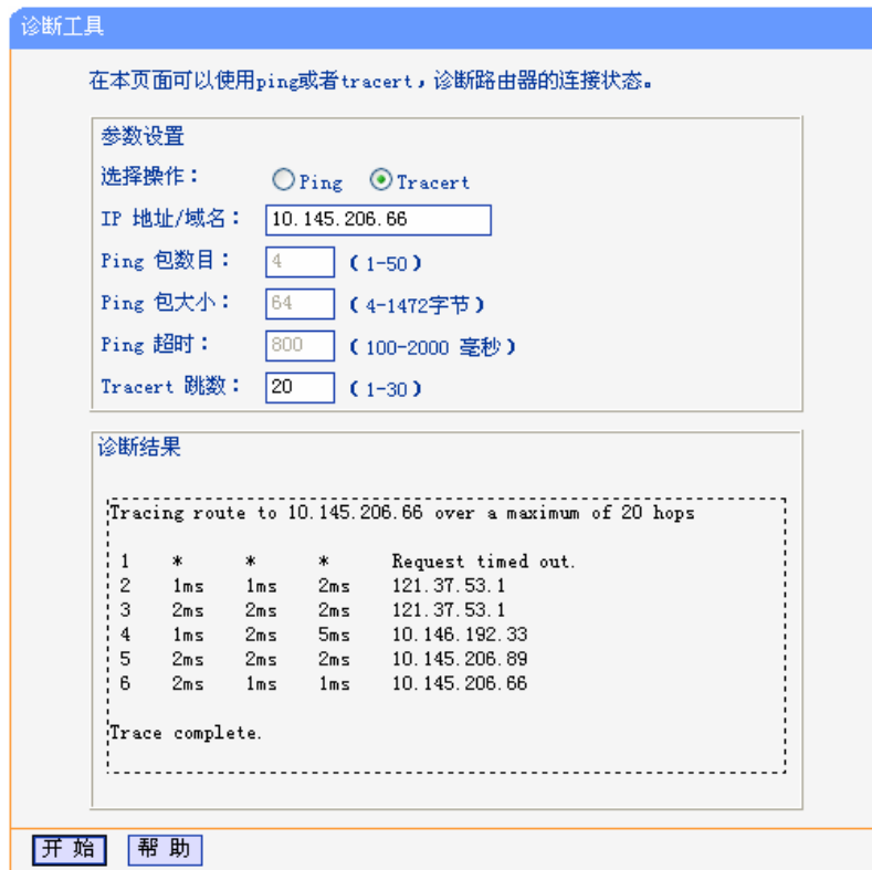
图 5-60 Tracert 诊断结果—成功
