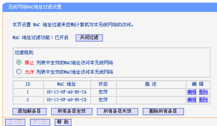
图 5-15 无线网络 MAC 地址过滤设置
