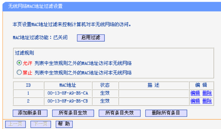
图 5-19 无线网络 MAC 地址过滤设置
