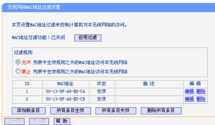
图 5-16 无线网络 MAC 地址过滤设置
