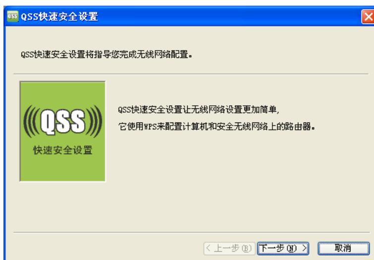
2. 在随后出现的如下图所示的界面中选择最后一项，并在“路由器 PIN”后面的方框中输入路由器底部标贴上的 8 位 PIN 码，单击下一步。
