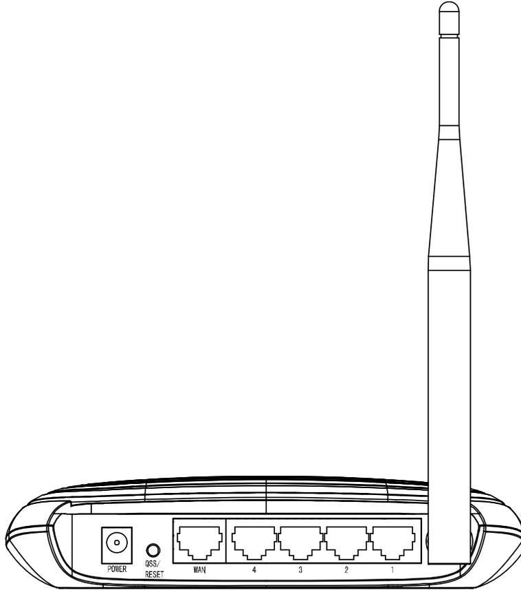
图 3-2 TL-WR740N 后面板示意图
