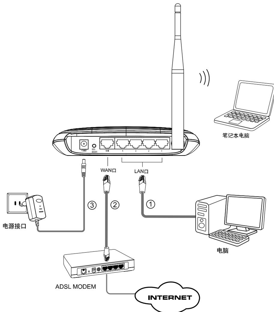
图 4-1 TL-WR740N 硬件安装示意图
