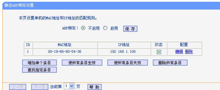
图 5-68 静态 ARP 绑定设置
