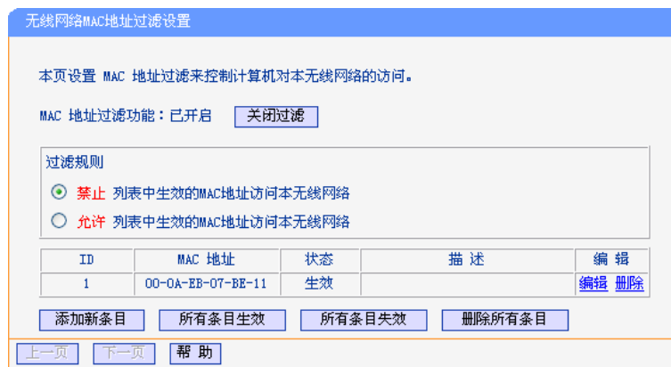
图 5-21 无线网络 MAC 地址过滤设置
