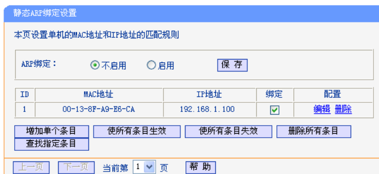
图 5-57 静态 ARP 绑定设置
