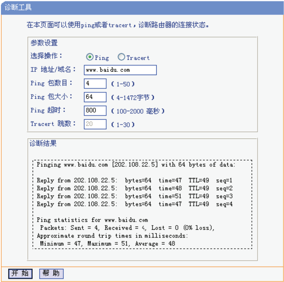
图 5-49 Ping 诊断结果—成功
