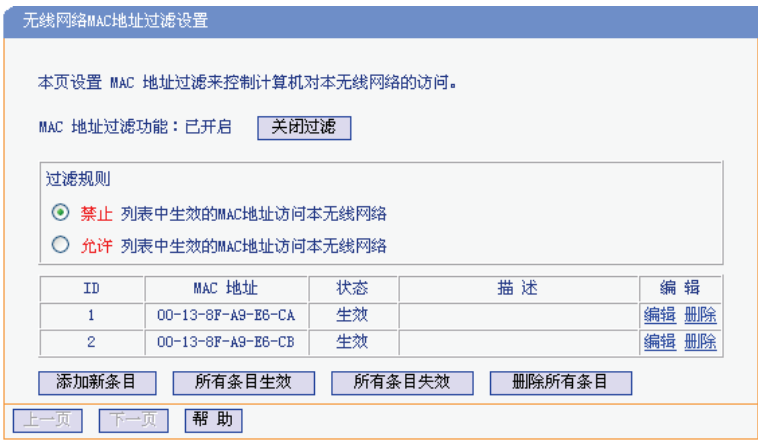
图 5-15 无线网络 MAC 地址过滤设置
