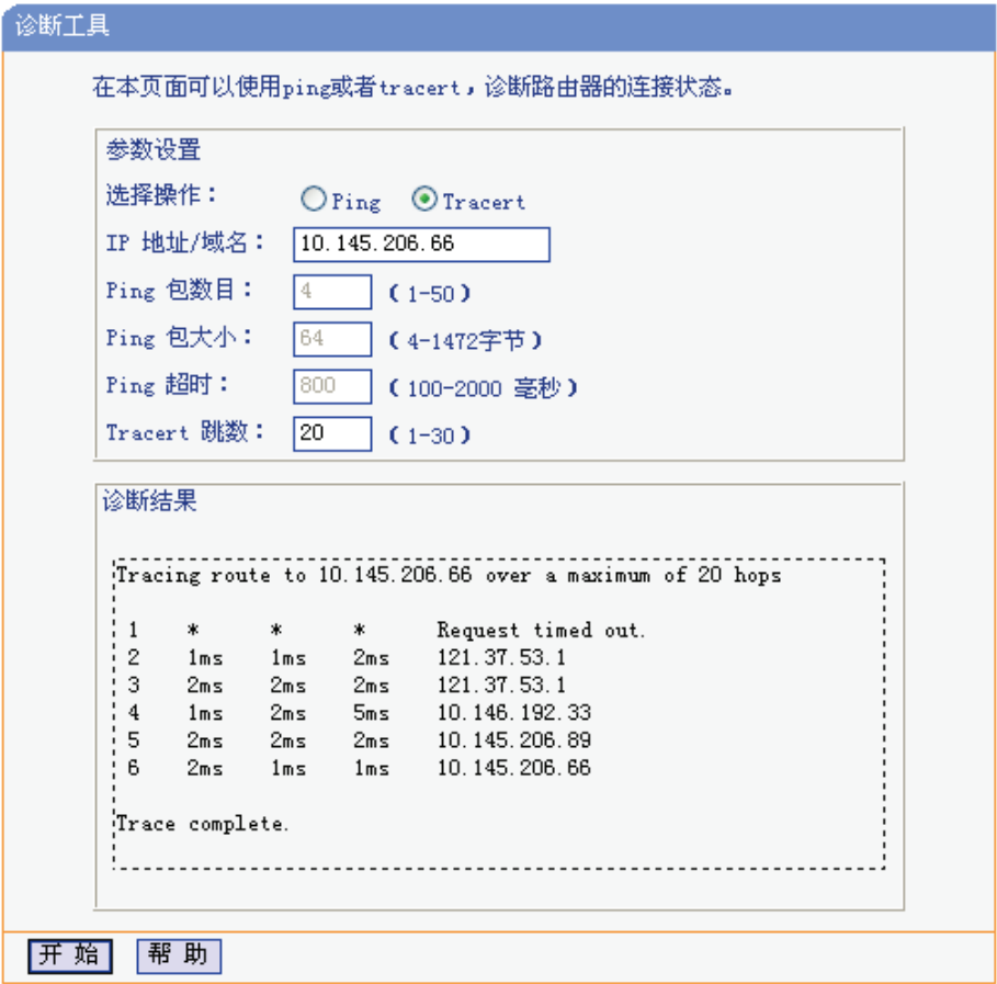
图 5-51 Tracert 诊断结果—成功
