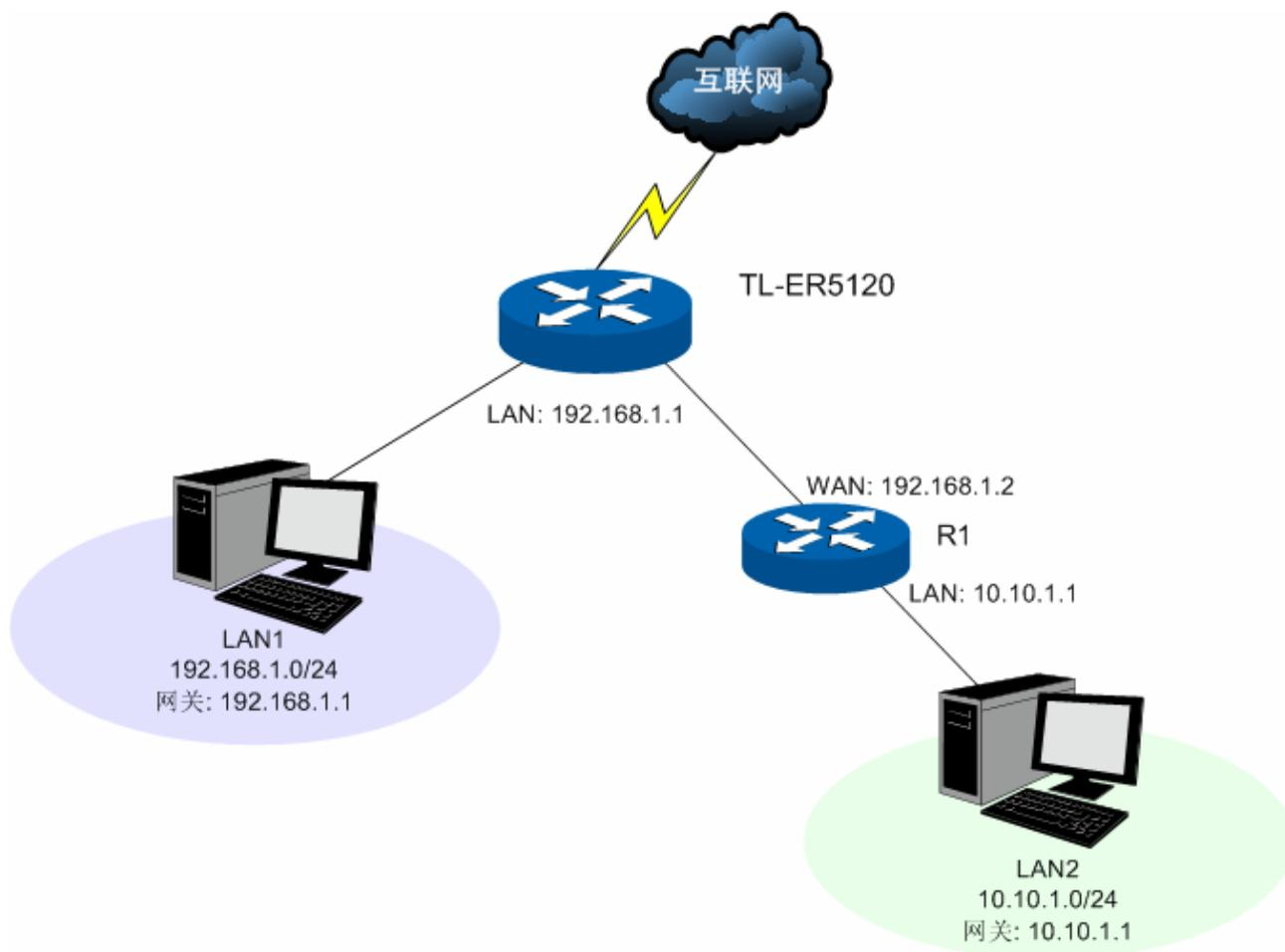
TL-ER5120 的 LAN 口连接 LAN1(192.168.1.0/24 网段)，同时级联另一路由器，该路由器连接 LAN2 (10.10.1.0/24 网段)，现在要实现 LAN1 中的主机能访问 LAN2。
