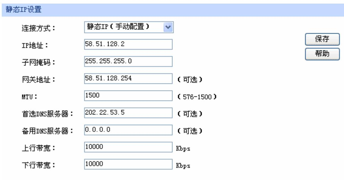
图 5-4 WAN 口设置静态 IP 连接方式
