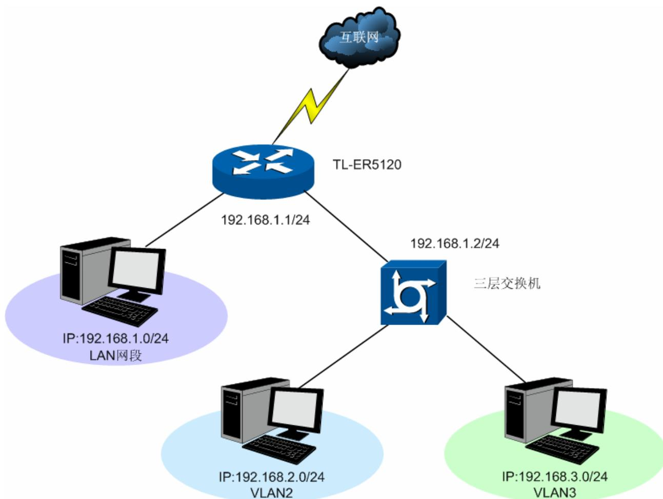
TL-ER5120 的 LAN 网段为 192.168.1.0 /24，三层交换机下 VLAN2 网段为 192.168.2.0 /24，VLAN3 网段为 192.168.3.0 /24，三层交换机与 TL-ER5120 的 LAN 口级联 VLAN IP 为 192.168.1.2。现要实现 VLAN2 和 VLAN3 网段可以访问互联网。
