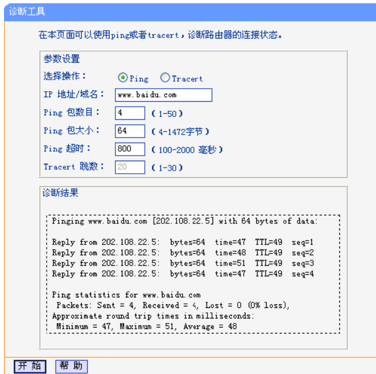
图 5-49 Ping 诊断结果—成功
