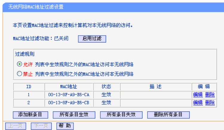
图 5-14 无线网络 MAC 地址过滤设置
