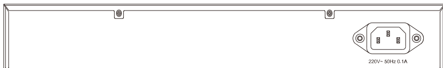
图 4-2 TL-SG1008 交换机后面板示意图
